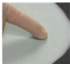
Mikroporen sind kaum sichtbar und führen häufig zu Lackierfehlern.
